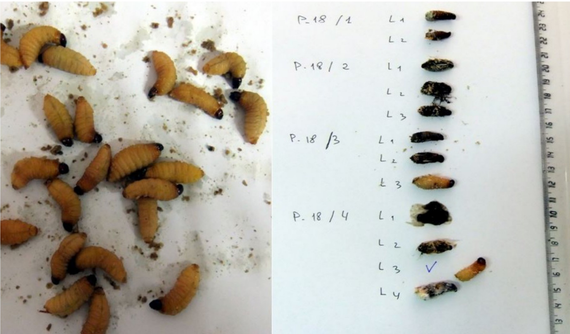
Figure 7. Le traitement par injection de Revive, même quand il a été appliqué un an avant, entraîne la mort de plus de 95% des larves : 80% meurent au bout de 15 jours ; parmi les survivantes, la majorité a perdu du poids et finit par mourir alors que dans un palmier non traité, le poids des larves est multiplié par deux à trois au bout de quinze jours. Ces résultats démontrent que, grâce à ce traitement, l'on peut protéger très efficacement les palmiers pendant un an. En appliquant ce traitement sur la majorité des palmiers situés en zone infestée, on interdit la dispersion et la multiplication du charançon rouge des palmiers, ce qui permet d'obtenir rapidement son éradication (Gómez & Ferry 2015).
